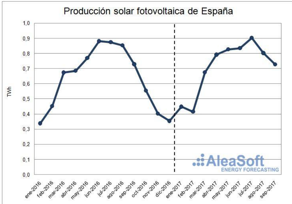
Evolución de la producción solar fotovoltaica de España. Fuente de datos: REE.
