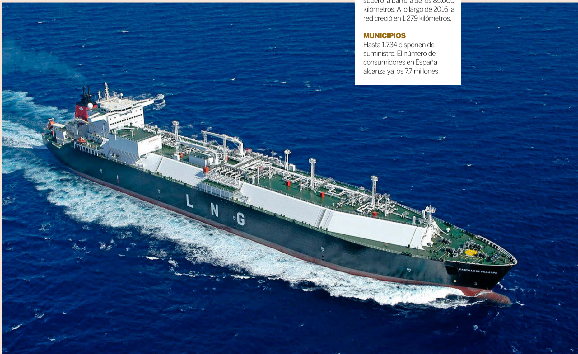
El Castillo de Villalba, buque español de transporte de GNL fletado por Gas Natural, alimenta sus motores con este combustible.
